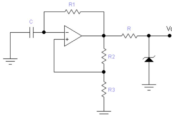
Il candidato illustri la funzione del diodo zener, dica quali sono i parametri da considerare nella scelta del componente elettronico e come individuare la resistenza R ( $V_{sat} = \pm 15V$ ). Inoltre individui i motivi per i quali la forma d'onda può modificarsi e diventare triangolare.
